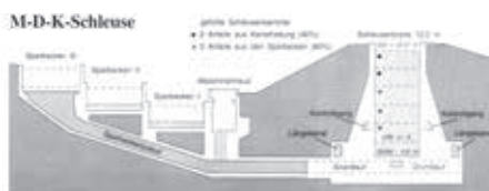
Die Sparschleusen mit Hubhöhen zwischen 17 und 25 m haben je zwei oder drei an der Seite terrassenförmig angeordnete Sparbecken, wodurch der Wasserbedarf der Kammer im Gegensatz zu einer Schleuse ohne Spareinrichtung um 60% verringert wird.
