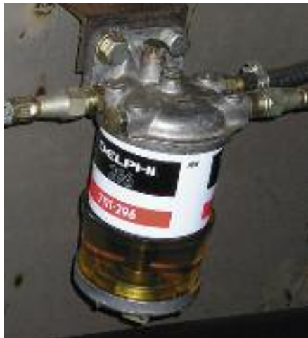
Wasserabscheider und Vorfilter Kombianlage
