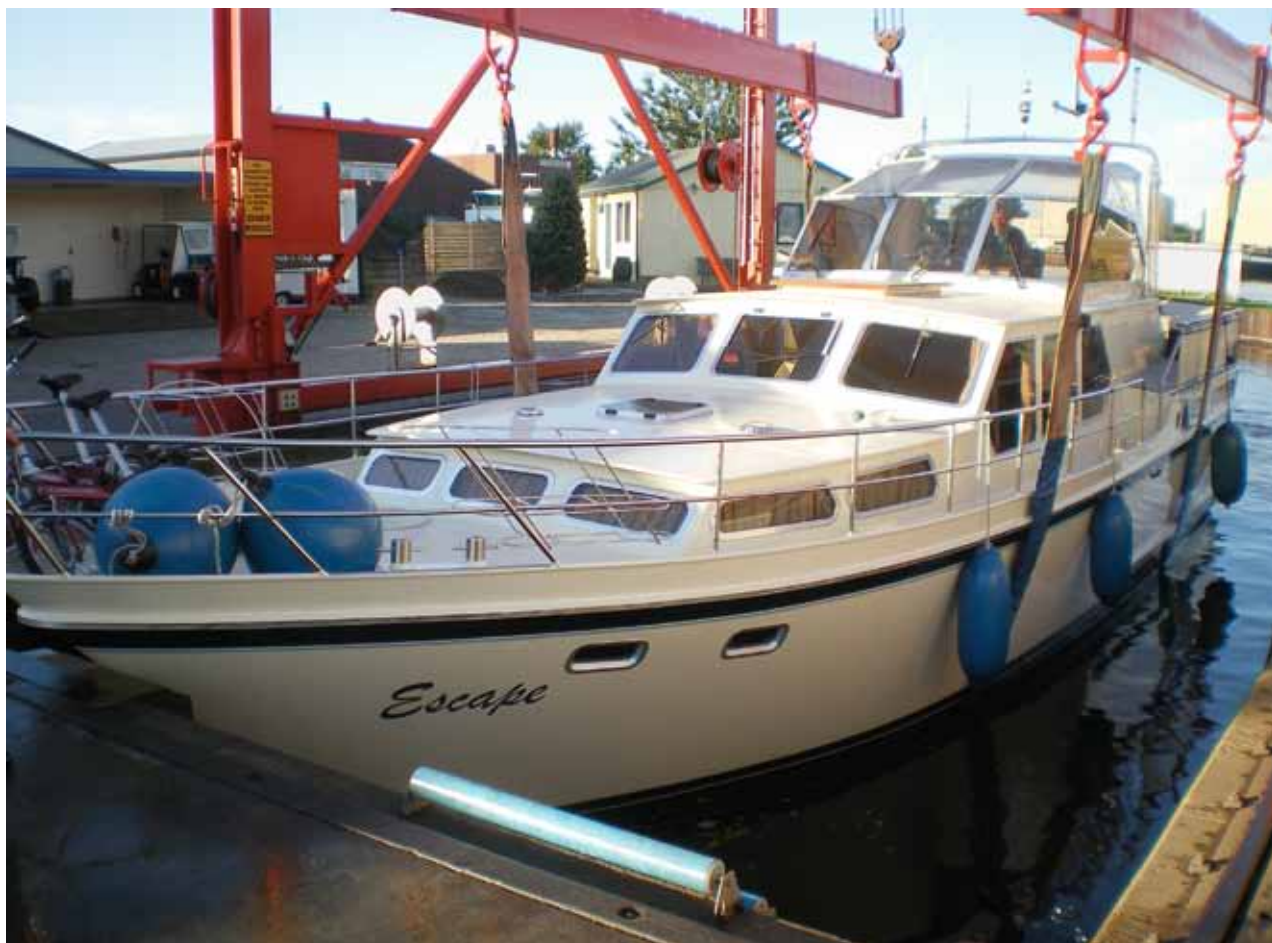
Escape (Valkkruizer 1400): Unser Favorit. «Escape im Lift» gehörte zur Prüfung, weil auch das Unterwasserschiff genauestens inspiziert wurde. Z. B. wurde die Materialstärke der Schale auf den Zehntelmillimeter geprüft. Nach fünf Stunden Inspektion lautet das Urteil: Alles bestens!
