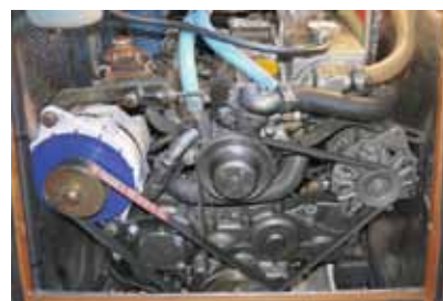
Beispiel-Motor mit Originalalternator (rechts) und nachgerüstetem (weiss/blauem) «IUoU» Kennlinienalternator für die Verbraucherbatterien
