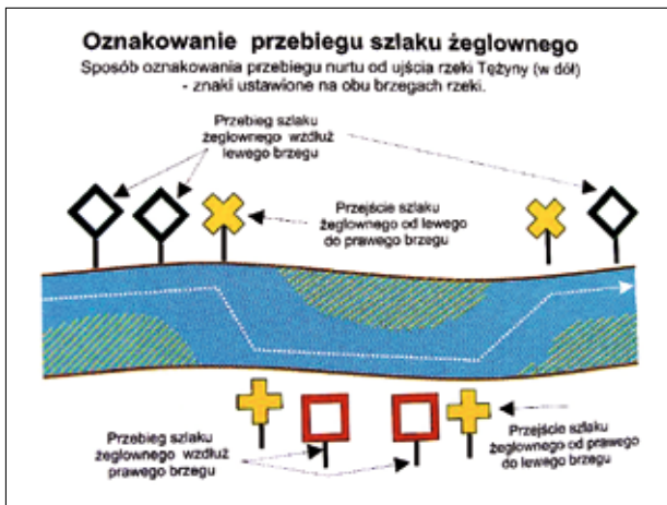
Markierungssystem auf Oder und Weichsel
