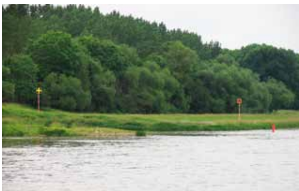
Fahrrinnenmarkierungen am rechten Ufer: Rote Quadrate und gelbe stehende Kreuze
