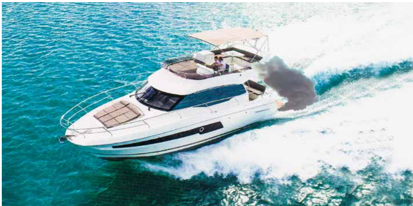
Auspuffgase gelangen bei Rückenwind in die Kabine oder bei geschlossenem Bimini auf die Fly
