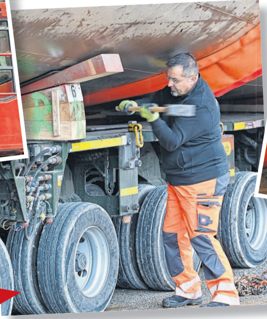
Das Schiff wird mit Ketten und Keilen fixiert, bevor die Kranbefestigung entfernt wird. Bilder Anouk Arbenz
